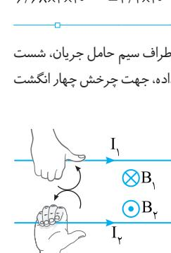
**پادآوری** برای تشخیص جهت میدان مغناطیسی اطراف سیم حامل جریان، شست دست راست را در جهت جریان الکتریکی سیم قرار داده، جهت چرخش چهار انگشت
